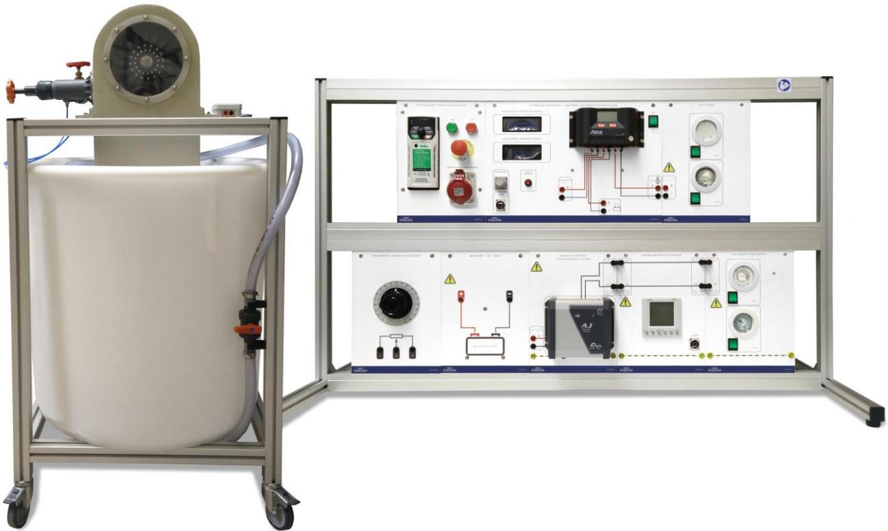
El equipo EN 05.1 está diseñado como una pequeña instalación de energía hidráulica con una turbina Pelton totalmente funcional, y todos los elementos necesarios para completar la instalación.
