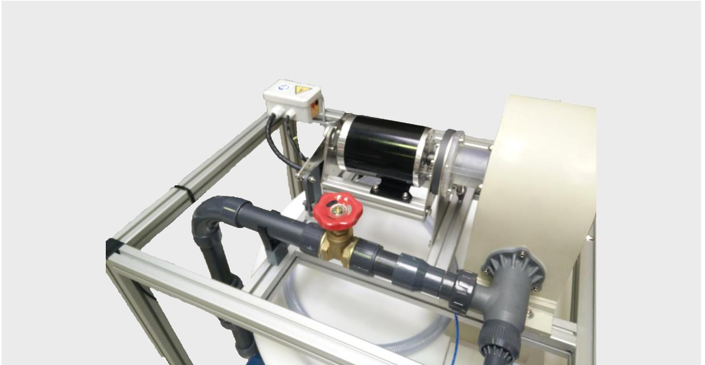
La forma constructiva del equipo permite visualizar todo el proceso de transformación de energía hidráulica / mecánica / eléctrica.
